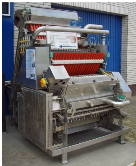
Abb. 26: Krabbenschälmaschine Fa. Kocken (heute Kocken & Ehlerding Krabbenhandels-GmbH), Spieka-Neufeld
