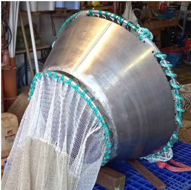
Abbildung 1: Strömungstrichter, angepasst für die Krabbenfischerei in der Nordsee.
